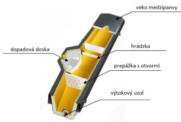
Obr. 3 Základné časti medzipanvy Error! Reference source not found.
