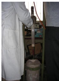
Priebeh procesu vysokoteplotnej chlorácie peliet
