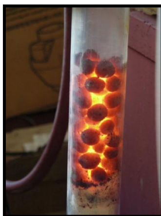
Obr. 2 Priebeg procesu vysokoteplotnej chlorácie peliet
