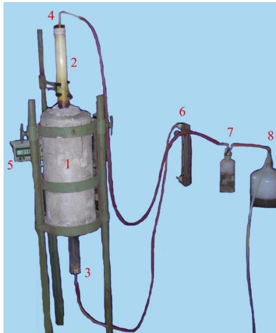
Experimentálne zariadenie na vysokoteplotnú chloráciu peliet
