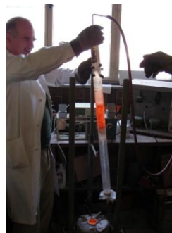
Priebeh procesu vysokoteplotnej chlorácie peliet
