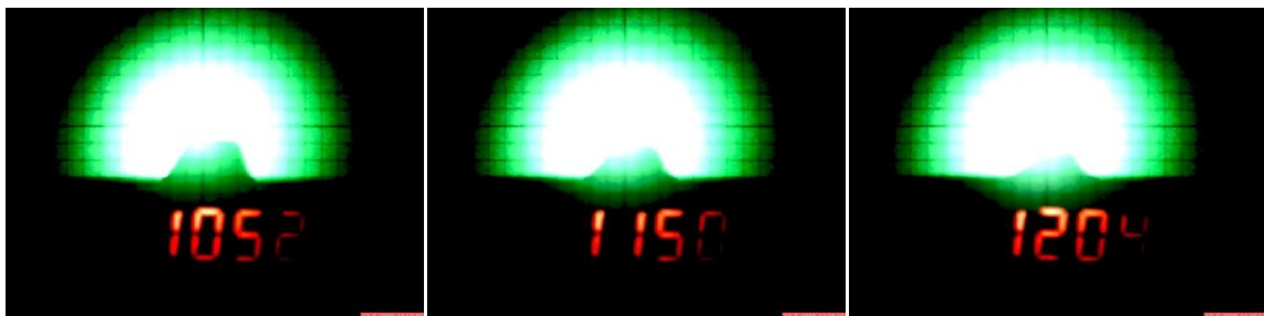
Obr. 3 Optické pozorovanie ohrevu vzorky elektródovej hmoty EH-PL
