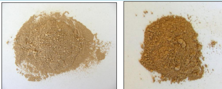
b) vysušený materiál Mg(OH)_2 c) MgO Obr. 1 Analyzované materiály na báze Mg(OH)_2 , resp. MgO
