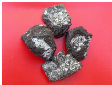
Obr. 4 Pohľad na častice CaO na povrchu analyzovanej vzorky 6
