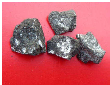
Obr. 4 Pohľad na častice CaO na povrchu analyzovanej vzorky 6
