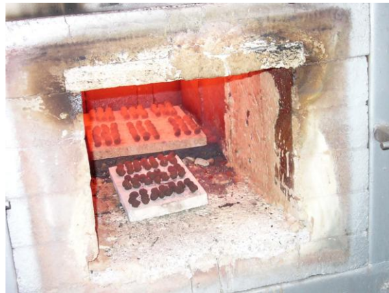
Obr. 3 Odporová pec a pelety pri vysokoteplotnom oxidačnom vypaľovaní
