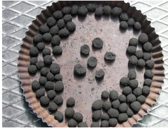
Obr.2 Zbalky homogénne po odtriedení materiálu (konvertorový jemný kal a prach)
