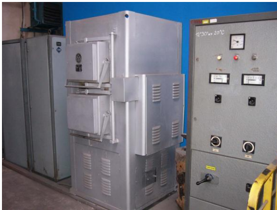
Obr. 3 Odporová pec a pelety pri vysokoteplotnom oxidačnom vypaľovaní
