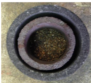
Obr.1 Vstupný materiál Shredder Sand umiestnený do téglíka
