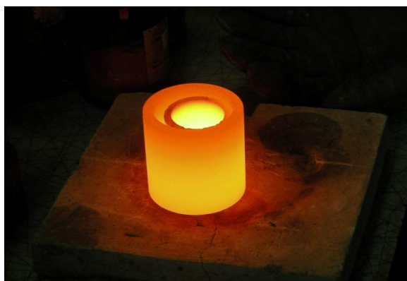
Obr. 2 Téglik po tavení (teplota tavenia = 1600°C, doba výdrže =10 min)
