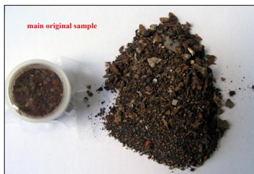
Obr.1 Vstupný materiál Shredder Sand umiestnený do téglíka
