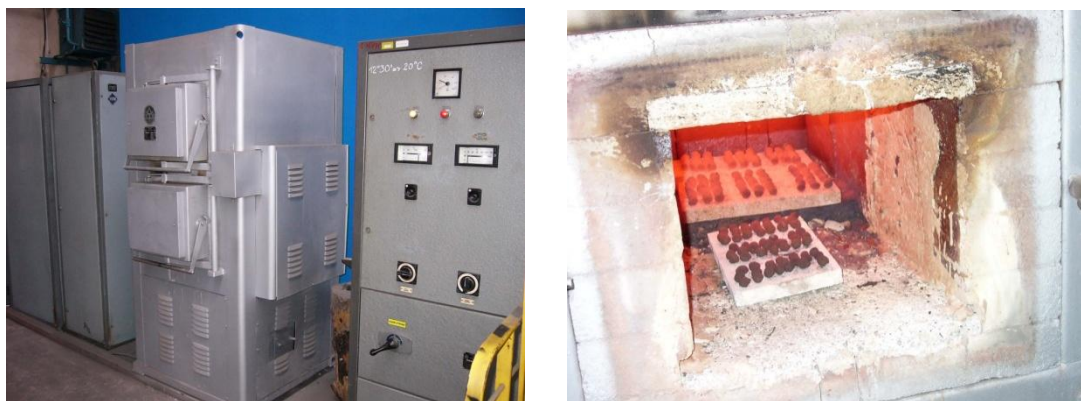
Elektrická odporová pec a vypálené pelety
