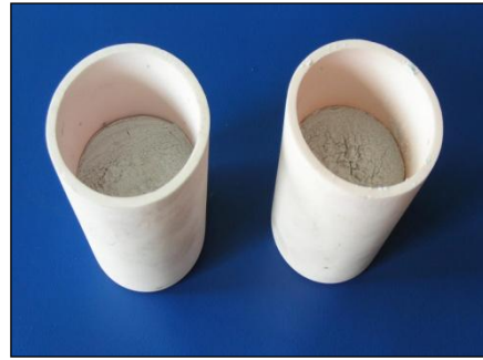
Obr. 3 Komorová odporová pec a téglíky s materiálom na báze \text{Ca}(\text{OH})_2
