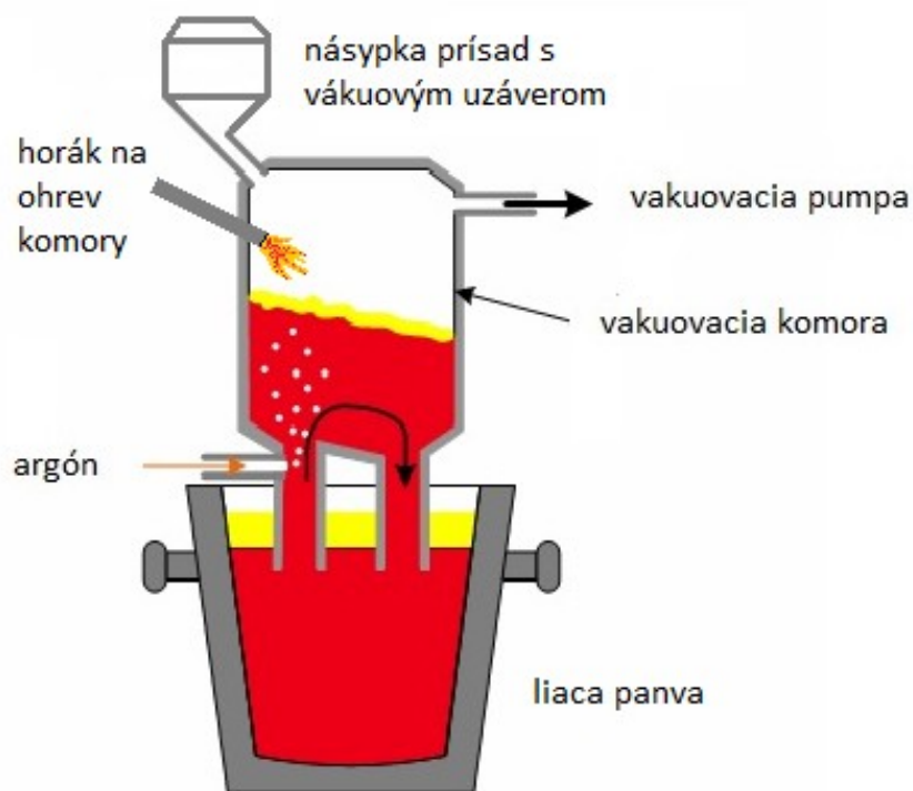
Obr. 8 RH – Vákuovací systém s obehom taveniny
