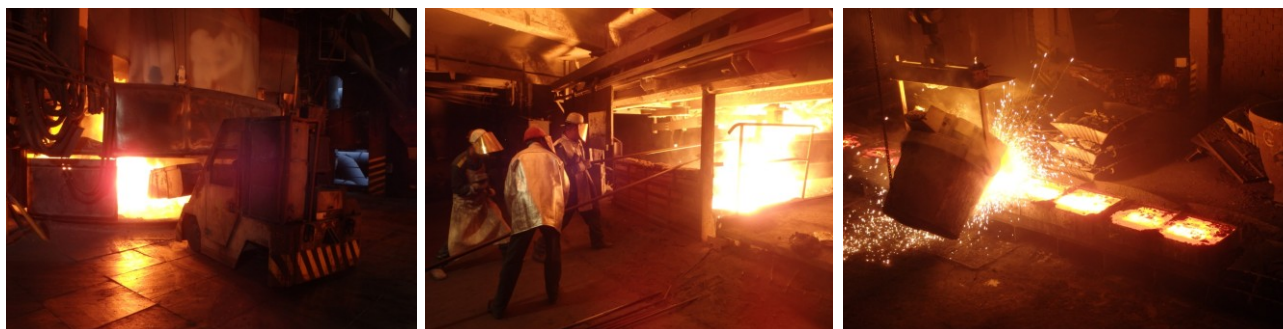
Obr. 9 Výroba, odpich a odlievanie ferozliatin v OFZ, a.s. http://www.ofz.sk/
