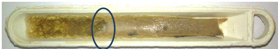
Obr. 7 Príklad vzorky so znázorneným intervalom teploty tavenia trosky
