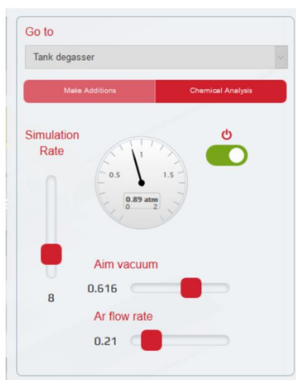
Obrázok 25 Ukážka kontrolného panela pre vákuové odplynenie
